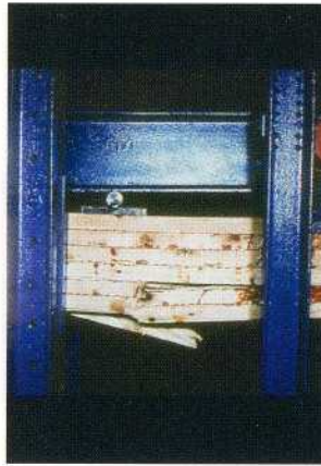
Bild 9: Untersuchungen der Bauakademie der DDR und des Forschungsinstituts des Kombines Bauelemente und Faserbaustoffe, Leipzig zum Einfluss der Trägerhöhe auf die Biegefestigkeit von Brettschichtholz
