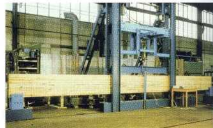
Bild 13: Traglastversuch im Rahmen eines Forschungsvorhabens an der Bauakademie der DDR zum Einfluss einer Verstärkung von Brettschichtholz mit glasfaserverstärkten Kunststoffen auf die Biegefestigkeit
